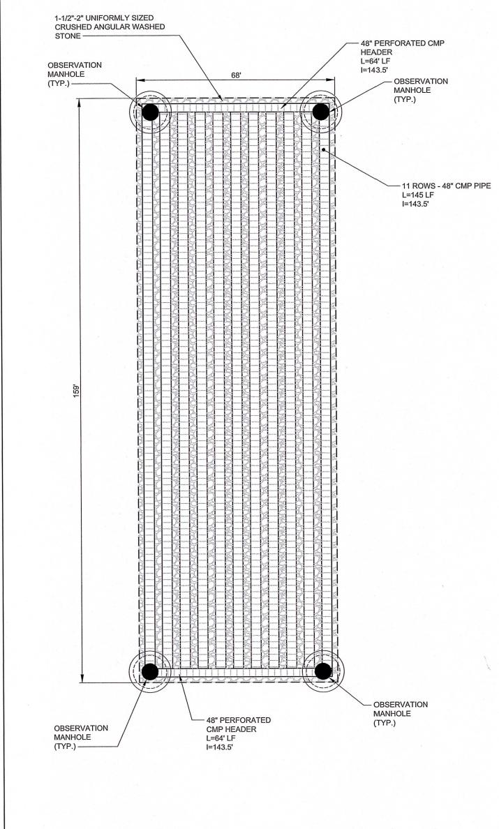
SUBSURFACE INFILTRATION SYSTEM LAYOUT
